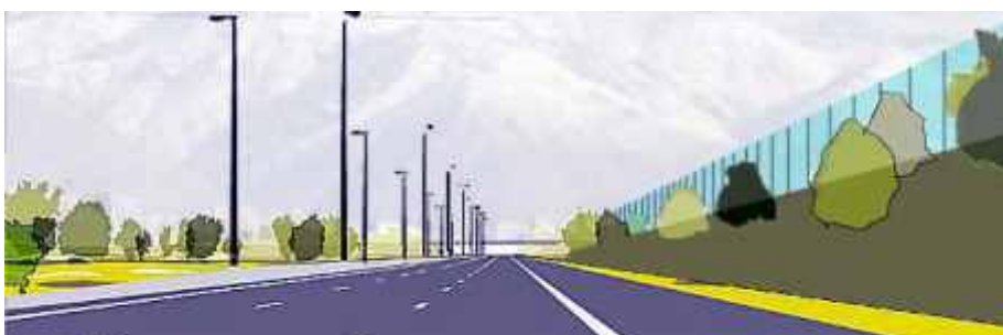
Highway mit Beleuchtung auf dem Mittelstreifen, Lärmschutzwand auf dem Damm
