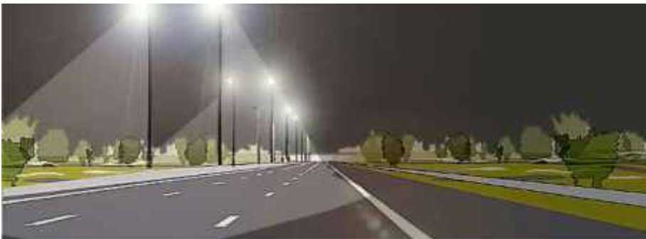
Beleuchtung auf dem Mittelstreifen
