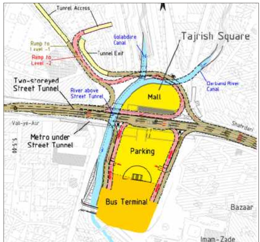
Tunnelverlauf im Bereich Tajrish-Square
