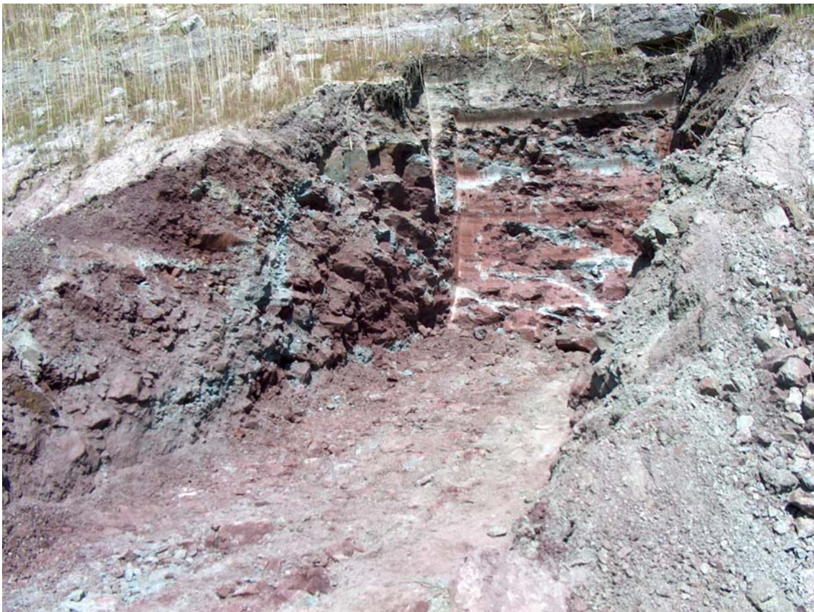
Bild 5 Erkundungsschurf im Feuerleitetonstein mit fossilen Trennflächen
