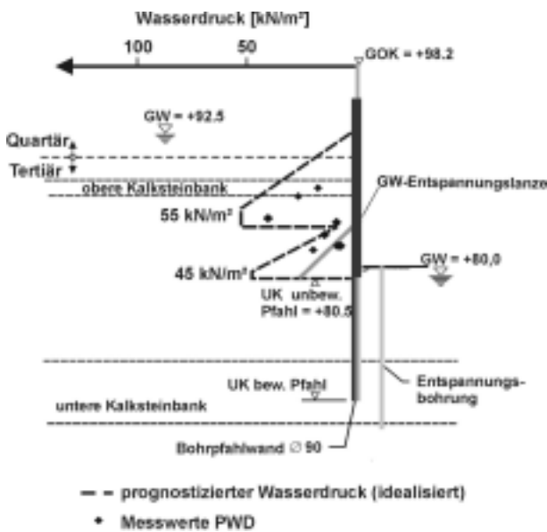
BILD 10 WASSERDRUCKVERLAUF, VERGLEICH ZWISCHEN PROGNOSE UND MESSUNG
